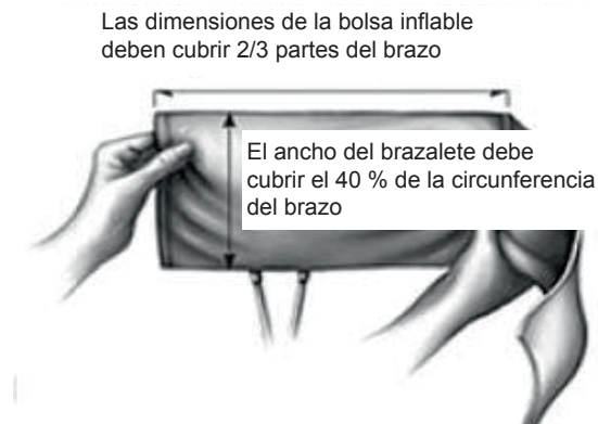
Figura 2 Estimación del tamaño del brazalete en relación con la circunferencia del brazo. Las dimensiones de la bolsa inflable del brazalete deben cubrir del 80 al 100 % de la circunferencia del brazo
