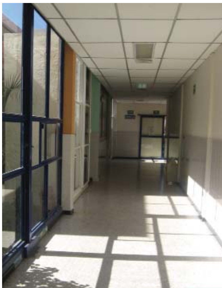
Figura 1 Incidencia solar a través de una placa de silicato sódico hacia el interior de un recinto a las 11 horas en el mes de enero. El vidrio de las ventanas impide la exposición a radiación UVB. La irradiancia UVA es de 10.8 mW/cm 2 . Para obtener una dosis de 1 J/cm 2 se requiere 1 minuto y 30 segundos
