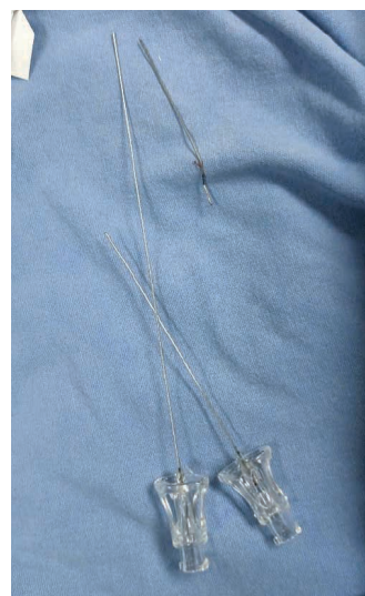
Figura 2 Aguja rota inmediatamente después de su extracción
